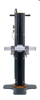
Das Kistenhubgerät KetLift4Box besteht aus einem leistungsstarken elektrischen Spindelantriebssystem, welches Lasten mit einer Masse von bis zu 100 kg (Quick) oder 200 kg (Strong) auf eine ergonomische Arbeitshöhe heben kann.
